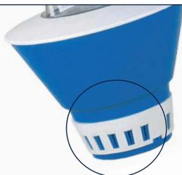
Der integrierte Verstellring befindet sich unter Wasser. Der **Ocean® deluxe Dosierschwimmer** erlaubt so eine individuelle Dosierung. Abhängig davon, wie weit der Austrittslücken geöffnet werden, einweicht Chlor ins Poolwasser. Der transparente Deckel lässt sofort erkennen, ob eine neue Chlortablette nachgefüllt werden muss.
