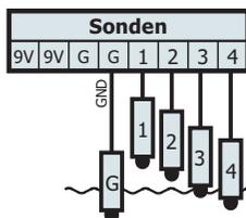
→ Die gemeinsame Bezugs Elektrode (G) muss tiefer als alle anderen Sonden montiert werden. Sonde 1 ist die oberste, Sonde 4 die unterste. Jede Sonde hat ein
