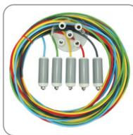
Fünf **Hängeelektroden** mit je 5m Spezialkabel und der **Fixiereinheit**.
