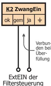
→ Schließen Sie daher die Klemmen "gem" – "ja" an die **ExtEin**-Klemmen der Filtersteuerung an.
