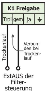
→ Schließen Sie daher die Klemmen "gem" – "Trol" an die **ExtAus**-Klemmen der Filtersteuerung an.
