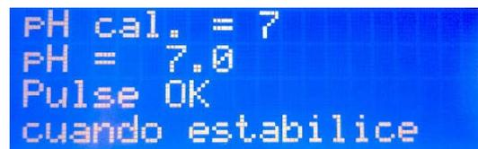
Jetzt werden Sie in der ersten Zeile des Displays zur Verwendung der pH4-Standardlösung aufgefordert. Sensor aus der ersten Lösung herausnehmen, schütteln und mit Wasser abspülen. Dieses Wasser durch erneutes Abschütteln beseitigen. Vorsichtig mit trockenem Tuch trocknen, ohne zu reiben. Sensor in die pH4-Standardlösung eintauchen.
