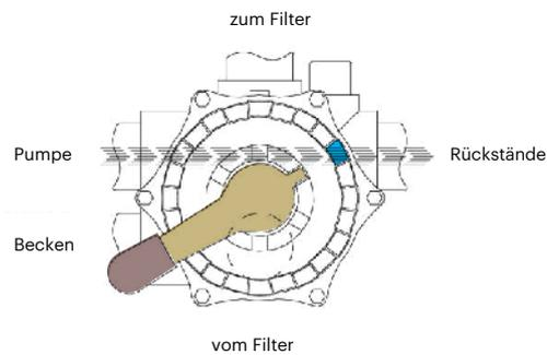
Den Hebel in die Position Entleeren stellen. Das Abflussventil ist geöffnet. Halten Sie die Pumpe nicht an, bevor nicht das Becken vollständig entleert ist, und achten Sie darauf, dass sowohl das Skimmer- als auch das Reinigerventil geschlossen sind.
