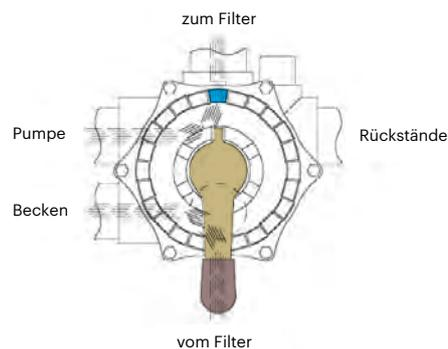
Stellen Sie den Ventilgriff bei ausgeschalteter Pumpe in die Position Filtration. Starten Sie die Pumpe.
