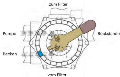
In dieser Stellung kehrt das Wasser in das Becken zurück, ohne durch den Filter zu fließen.
