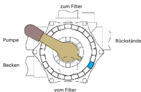
Diese Hebelstellung schließt den Durchgang vom Filter zur Pumpe. Sie dient zum Öffnen des Pumpendeckels und zur Reinigung des Pumpenkorb (Vorfilter).
