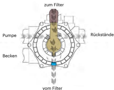
Wenn die Verunreinigung im Filtermittel zurückbleibt, steigt der Druck im Manometer auf 1,3 bar. Halten Sie die Pumpe an. Den Hebel in die Position Reinigen stellen. Ventil, Abfluss, Skimmer, offen. Ablassventil geöffnet. Die Pumpe zwei Minuten lang laufen lassen.
