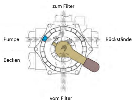
Nach dem Reinigen den Griff in die Spülposition stellen, die Pumpe eine Minute lang einschalten und dann den Griff in die Position Filtration stellen.
