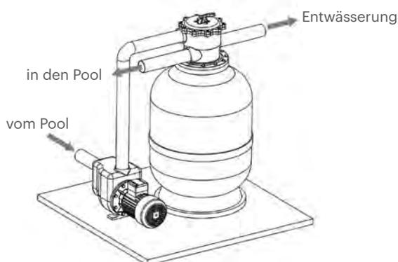
Der Filter sollte so nah wie möglich am Pool installiert werden, vorzugsweise in einer Höhe von 0,50 m unter der Wasseroberfläche des Beckens. Im Maschinenraum, in dem der Filter untergebracht ist, sollte sich ein Abfluss befinden.
