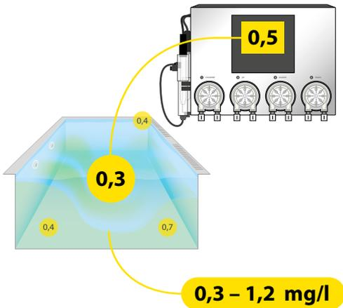
Eine Kalibrierung ist nicht erforderlich, wenn die Differenz zwischen dem **Messwert** des Photometers und dem auf dem Display **angezeigten Wert** kleiner als **0,2 mg/l**.
