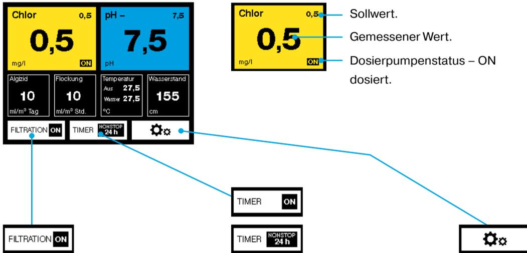
**ON/OFF** signalisiert den aktuellen Zustand der Filtration.
