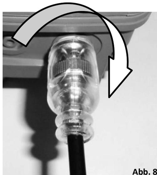
Den Stecker um 1/4 -Umdrehung drehen, um den Anschluss zu sichern.
