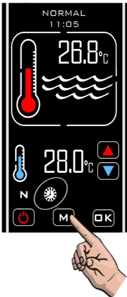
In diesem Modus heizt der Regler nur innerhalb eines zeitlich festgelegten Zeitraums und nur bei Eingang eines ausreichend hohen Durchflusses.
