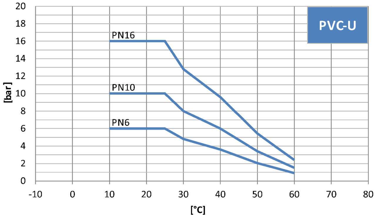
Die Werte des Druck-Temperatur-Diagramms basieren auf einer Lebensdauer von 25 Jahren bei statischer Druckbelastung und gelten für Wasser oder wasserähnlichen Medien
