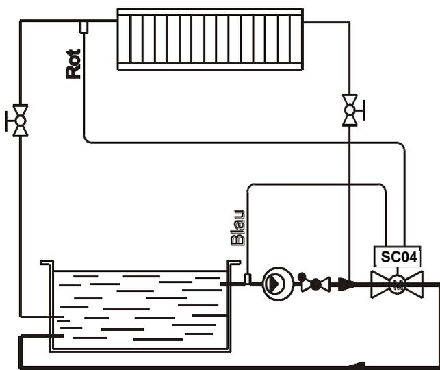
Nach dem Einstecken der Steuerung leuchtet die GRÜNE – LED **[1]** für POWER (in Betrieb) auf, das Gerät ist betriebsbereit. Der Kugelhahn stellt auf Position 1 „OFFEN“ Das Poolwasser wird durch die Filteranlage wieder zurück in den Pool gepumpt. Potentialfreier Kontakt **[a - b]** ist offen, kein Durchgang.
