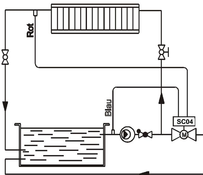
**Bei der Fühlermontage darauf achten, dass die jeweiligen Fühler so nah als möglich bei dem zu messendem Medium (z.B. Wasser) montiert werden!**
