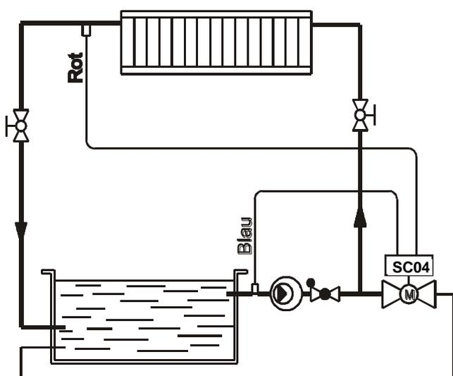
Sinkt die Pooltemperatur um 1,5°C unter die eingestellte Solltemperatur **[3]** und die Kollektortemperatur steigt um mehr als 4°C über die der Solltemperatur **[3]**, stellt das Gerät automatisch auf Position 2 „Heizen“ um ( Kugelhahn ist geschlossen ) ROTE - LED **[2]** leuchtet. Das Poolwasser wird jetzt durch die Kollektoren gepumpt und dadurch erwärmt.
