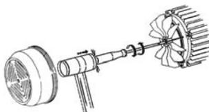
Prüfen, ob die Drehrichtung des Motors mit der Angabe auf dem Typenschild übereinstimmt (der Lüfter des Motors muß sich von hinten gesehen im UHRZEIGERSINN drehen). Bei einer Pumpe mit Dreiphasenmotor müssen bei falscher Drehrichtung zwei Phasen der Netzzuleitung am Schutzgerät vertauscht werden.
