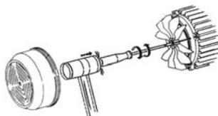
Zkontrolujte, zda směr otáčení motoru souhlasí s údajem uvedeným na výkonovém štítku (vrtulka ventilátoru se musí při pohledu zezadu točit VE SMĚRU HODINOVÝCH RUČÍČEK). Jestliže se jedná o třífázový motor a zjistíme, že se točí opačným směrem, je nutno mezi sebou vyměnit na jističi dva fázové přívodní vodiče.
