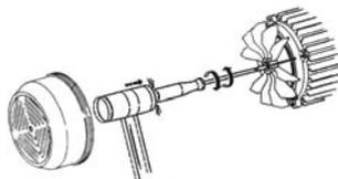
Verificare che il senso di rotazione del motore coincida con quello indicato sulla targhetta delle specifiche tecniche (il ventilatore deve ruotare, guardando dalla parte posteriore del motore, in SENSO ORARIO). Se la pompa è trifase e si osserva che il senso di rotazione è errato, si dovranno invertire due fasi di alimentazione del quadro di protezione.
