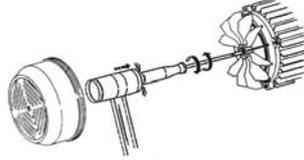
Motor şaftının (arkadan bakılarak) pompa üzerinde belirtilen yönde (SAAT YÖNÜNDE) döndüğünden emin olunuz. Eğer üç fazlı motorlarda şaftın ters yönde döndüğü tespit edilirse, güç sağlayan iki faz kontrol panosundan ters değiştirilmelidir.
